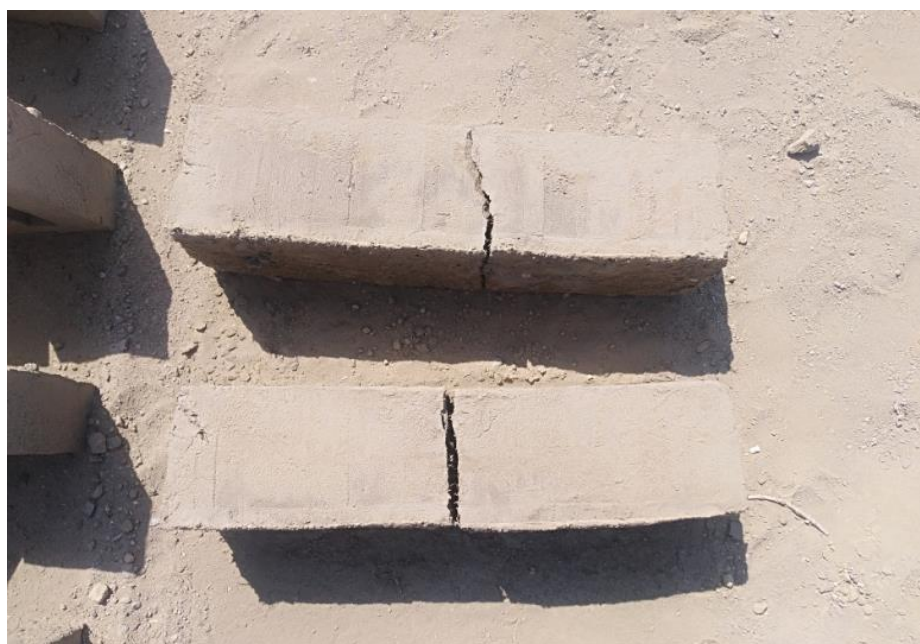
Figura 49 Rotura de vigas en las mezcla tradicional, común (67% Suelo arcilloso - 33% Arena negra fina)
