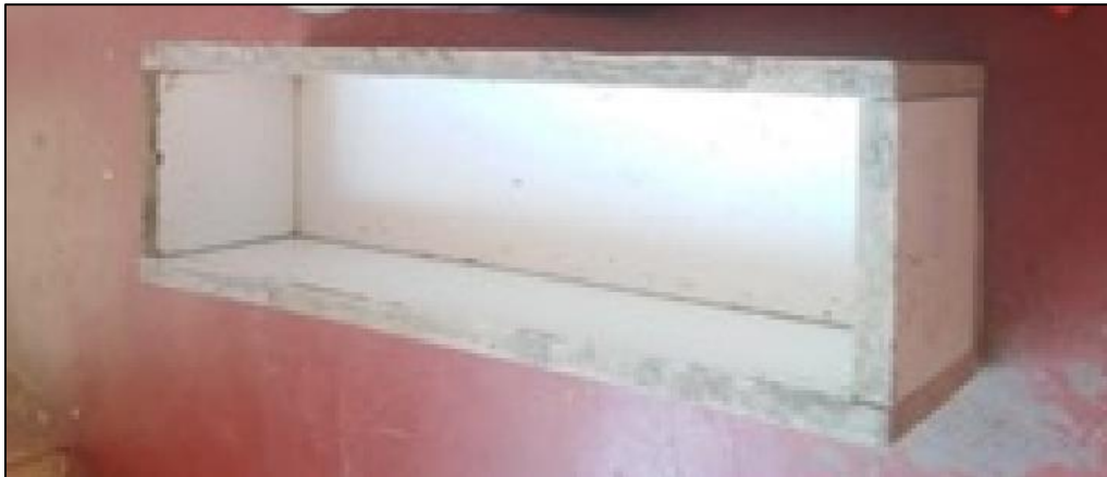
Figura 45 Molde para viga artesanal (50 x 15 x 15 cm)
