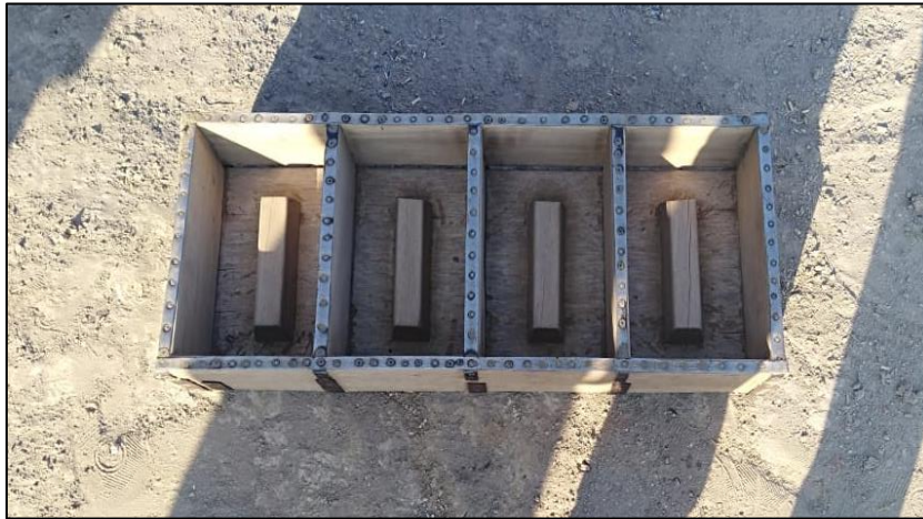
Figura 6 Moldes para ladrillo artesanal (23 x 13 x 9 cm)
