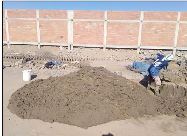
Figura 4 Mezclado de la materia prima
