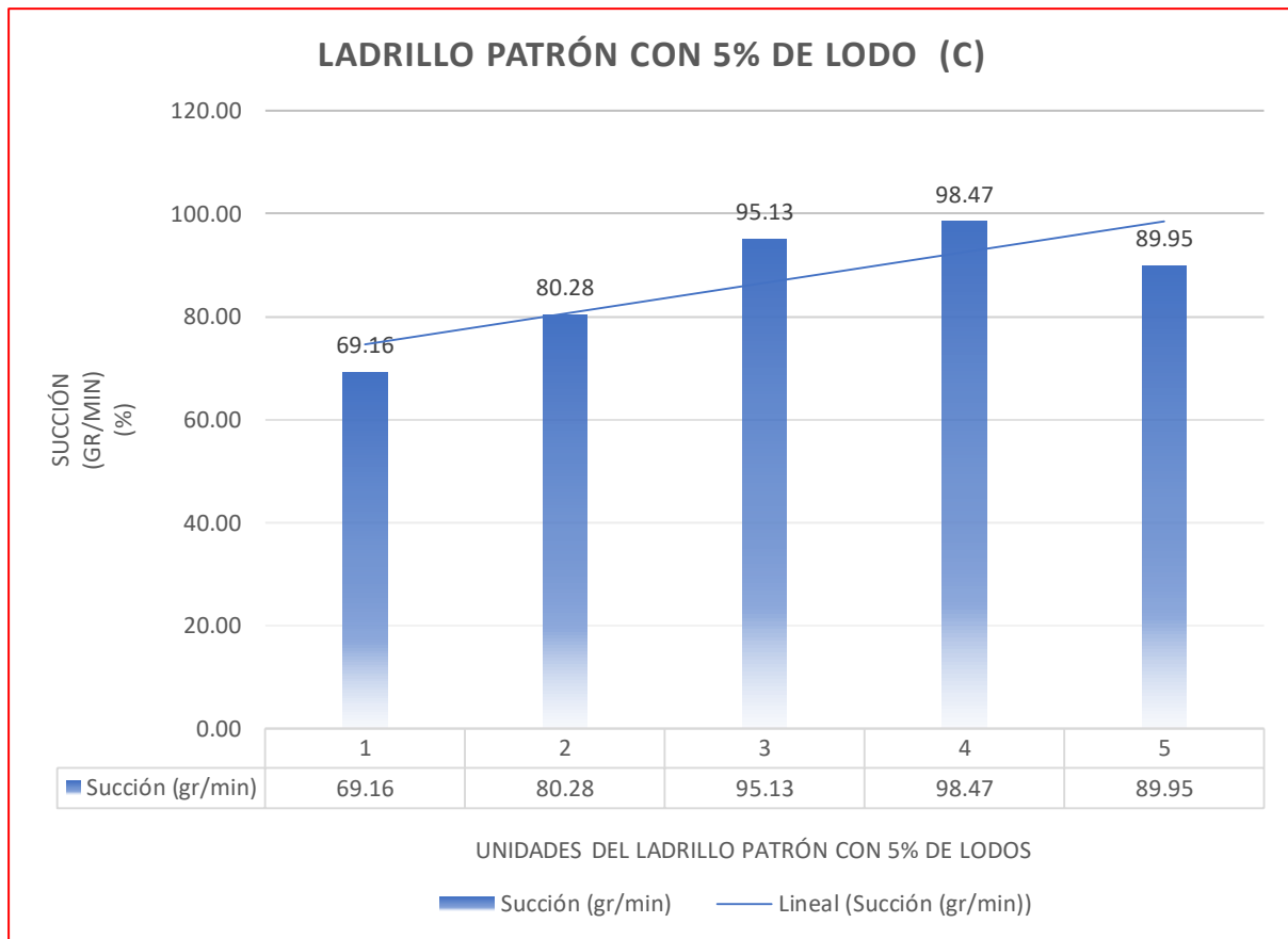
Gráfico 14 Resultados del ensayo: Succión del ladrillo tradicional de arcilla (Patrón) incorporando un 5 % de Lodo Seco de Agua Residual
