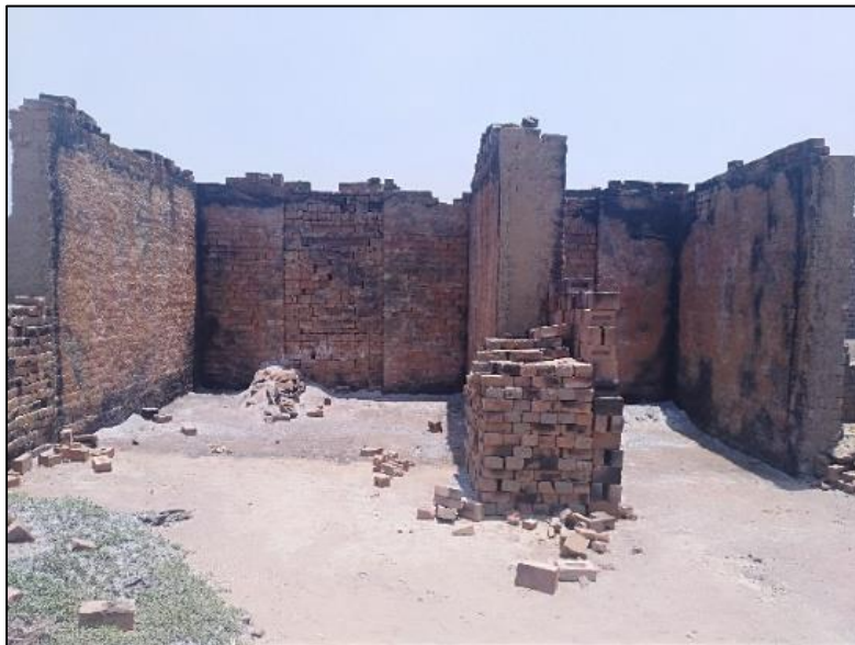
Figura 25 Horno artesanal de la ladrillera seleccionada
