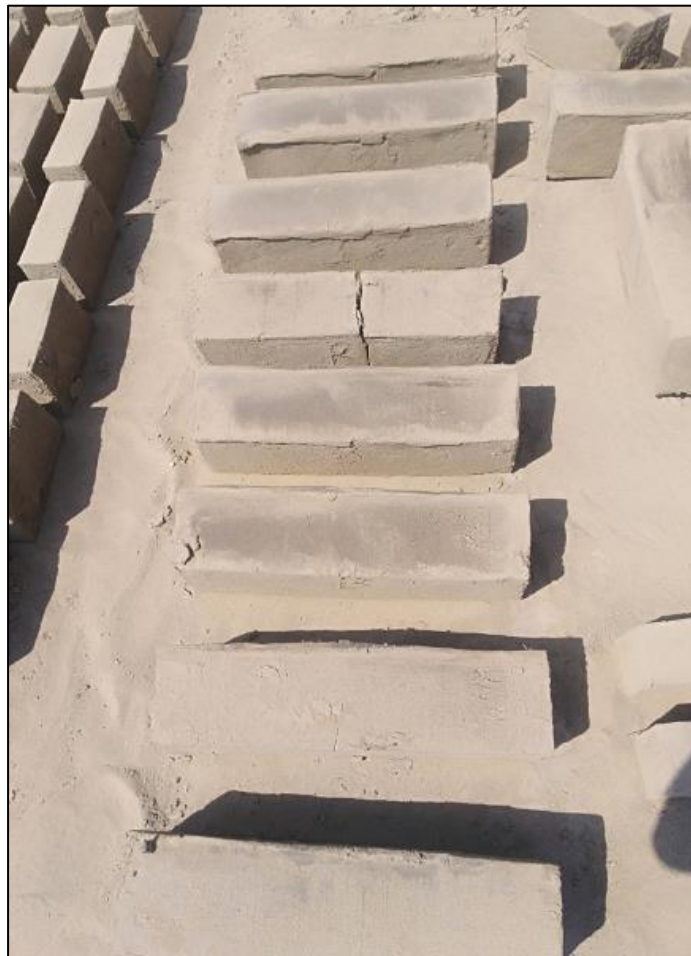
Figura 50 Rotura de viga en la mezcla mejorada, patrón (70% Suelo arcilloso - 30% Arena negra fina)
