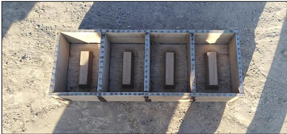
Figura 43 Molde para ladrillo artesanal tradicional (23 x 13 x 9 cm)
