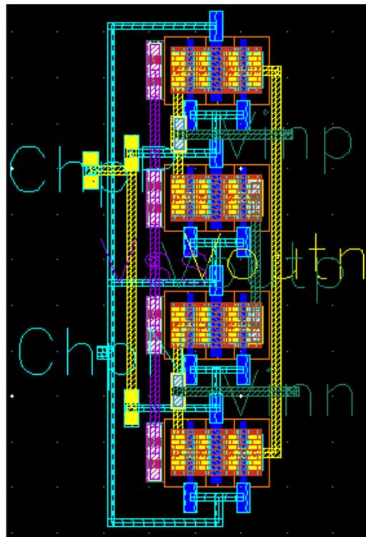
Figura 5.3: *Layout de um Modulador Chopper.*
