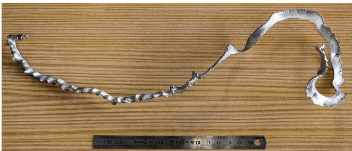
Figura 4.31 - Apara produzida no ensaio helicoidal cilíndrico.
