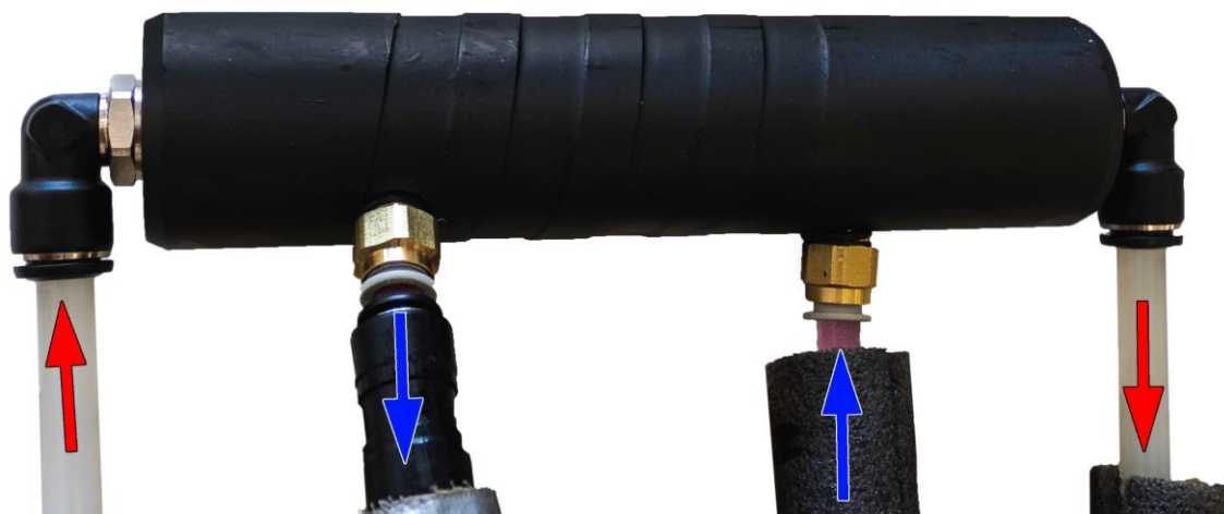
Figura 4.35 - Direções dos caudais no permutador térmico tubular. Caudal quente representado a vermelho e o frio a azul.
