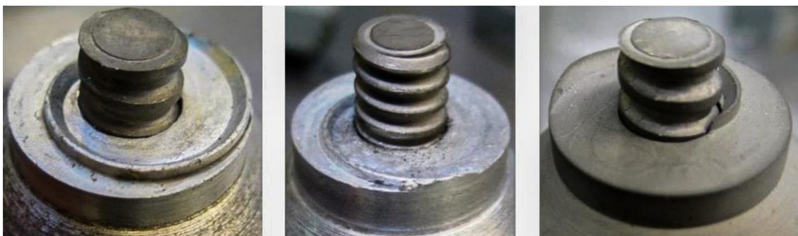
Figura 2.12 - Ferramentas utilizadas na técnica FSC without Clearance , adaptado de [2].
