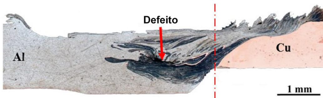
Figura 2.5 - Secção transversal do início de uma soldadura de tubos (AA3003 e Cobre puro), adaptado de [11].
