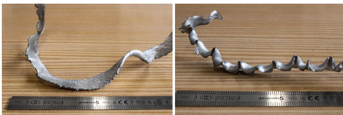
Figura 4.32 - Início (à esquerda) e final (à direita) da apara produzida no ensaio helicoidal cilíndrico.
