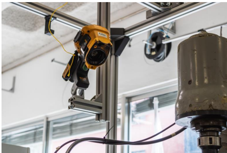
Figura 3.5 – Montagem da câmara termográfica.
