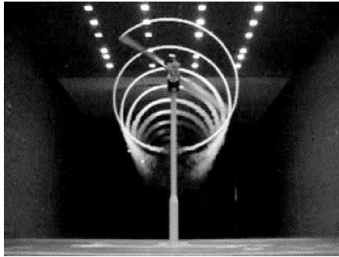
Figura 2.5: Visualização da espiral de vórtices de ponta, com injeção de fumo nas pás do modelo para a turbina de NREL. Fonte: Vermeer, Sørensen e Crespo, 2003
