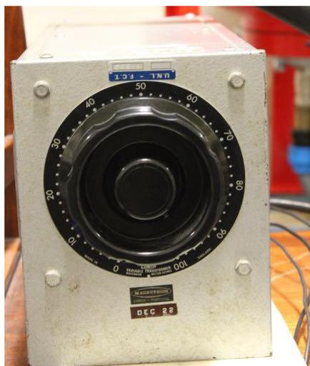
Figura 4.1 Autotransformador 3 fases
