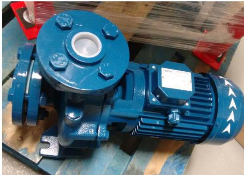
Figura 3.6 Bomba Centrífuga Monobloco Caprari CM32-16C
