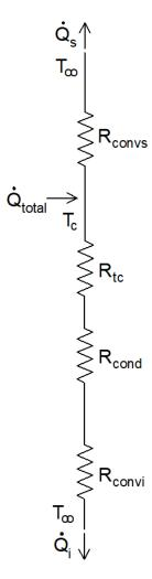
En este caso, también del calor total que genera la tarjeta de circuitos,  $\dot{Q}_{total}$ , parte se disipa hacia la parte inferior,  $\dot{Q}_{i}$ , y parte hacia la superior,  $\dot{Q}_{s}$ :
