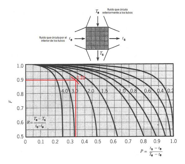
En la gráfica anterior se entra con los siguientes datos y se obtiene que F es aproximadamente 0,89. Nótese que, según la figura, t representa el fluido que circula por el interior de los tubos y T el que circula exteriormente a los tubos:
