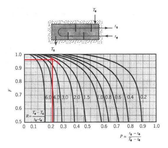
En la gráfica anterior se entra con los siguientes datos y se obtiene que F es aproximadamente 0,96. Nótese que, según la figura, t representa el fluido que circula por el interior de los tubos (en este caso el agua) y T el que circula exteriormente a los tubos (en este caso el aceite):
