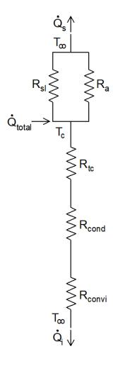
Del calor total que genera la tarjeta de circuitos,  $\dot{Q}_{total}$ , parte se disipa hacia la parte inferior,  $\dot{Q}_{i}$ , y parte hacia la superior,  $\dot{Q}_{s}$ :
