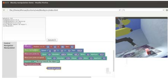
Figura 6: Interfaz de programación visual con Blockly para el simulador UWSim.
