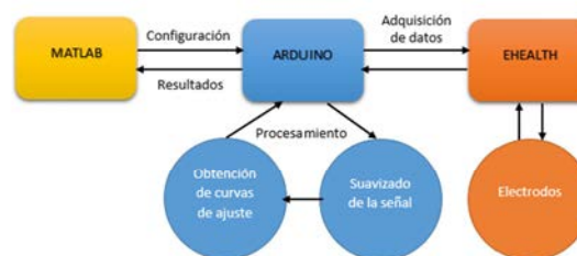
Figura 1: Diagrama de flujo de datos entre Matlab Arduino y eHealth.
