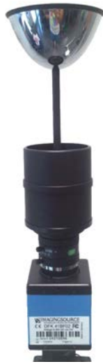
Figura 2: Sistema real de adquisición de imágenes omnidireccionales.
