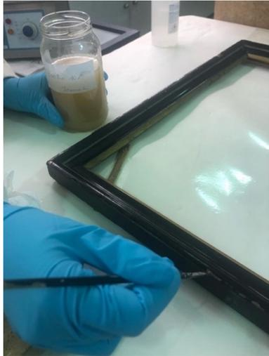
**Figura 59.** Fixação da camada cromática em destacamento.
