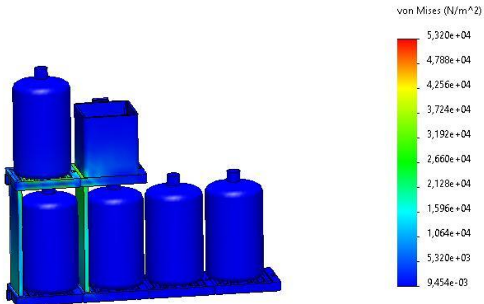
Fig 83. Análisis estático de garrafas grandes (2 pisos).
