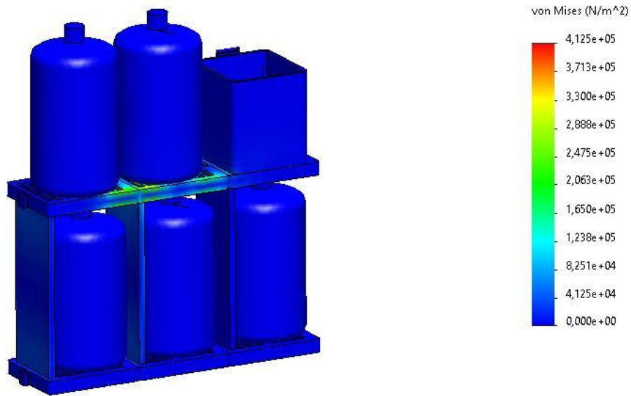
Fig 83. Análisis estático de garrafas grandes (2 pisos).
