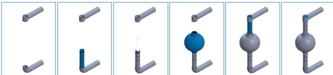
Imagen 72. Montaje para el adaptador de pared
