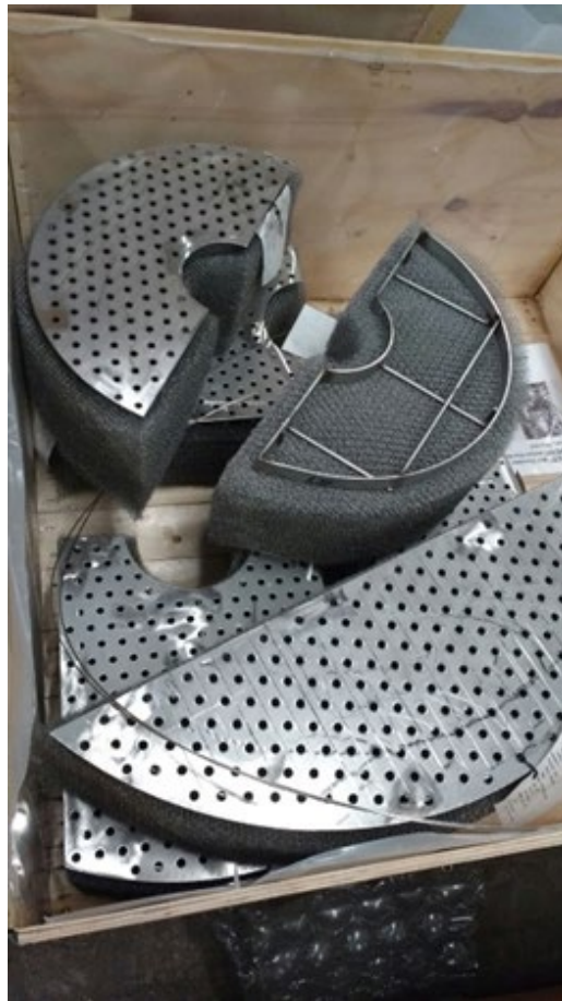
Fig.13 Extractores de nieblas de vapor (Frango Rico- Brasil)
