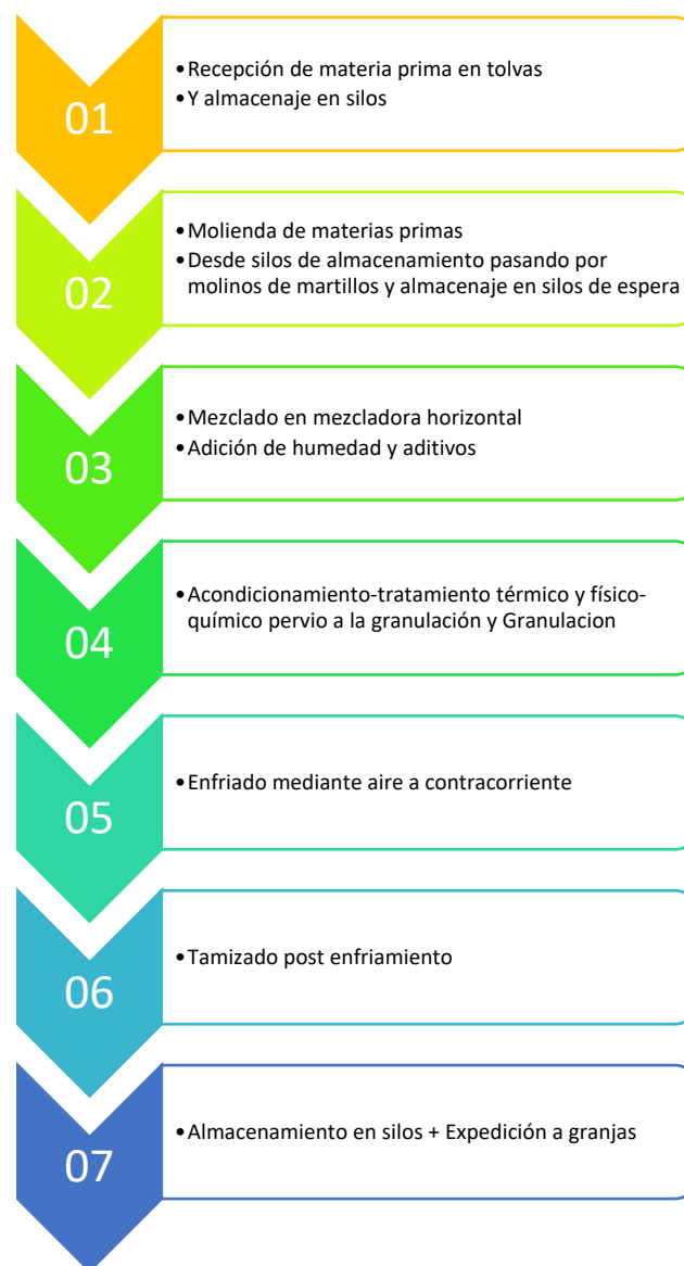
Fig.3 Diagrama de flujo del proceso de fabricación del pienso compuesto
