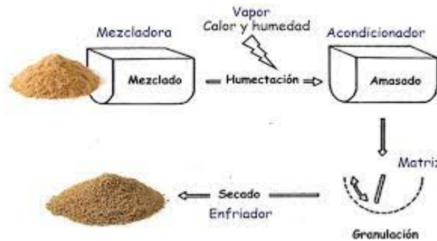
Fig.10 Esquema del proceso de granulación (Nutrofeed)
