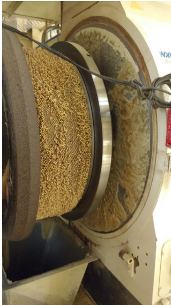
Fig.20 Vista del interior de la matriz de la granuladora después de una parada por sobrecalentamiento del motor al tener el pienso baja calidad y taponar los orificios de salida (Granuladora Andritz en Frango Rico-Brasil)
