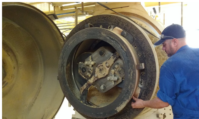
Fig.7 Granuladora ANDRITZ en mantenimiento (Frango Rico – Brasil)
