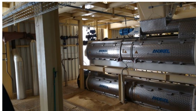
Fig.14 Acondicionador Andritz de doble etapa (Frango Rico-Brasil)
