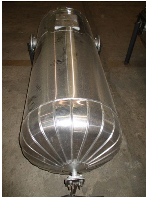
Fig.12 Exterior de un separador de nieblas de vapor (Frango Rico- Brasil)
