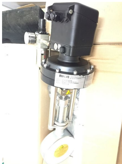
Fig.17 Válvula de control de precisión y elevada ganancia (Bvalve - Frango Rico- Brasil)
