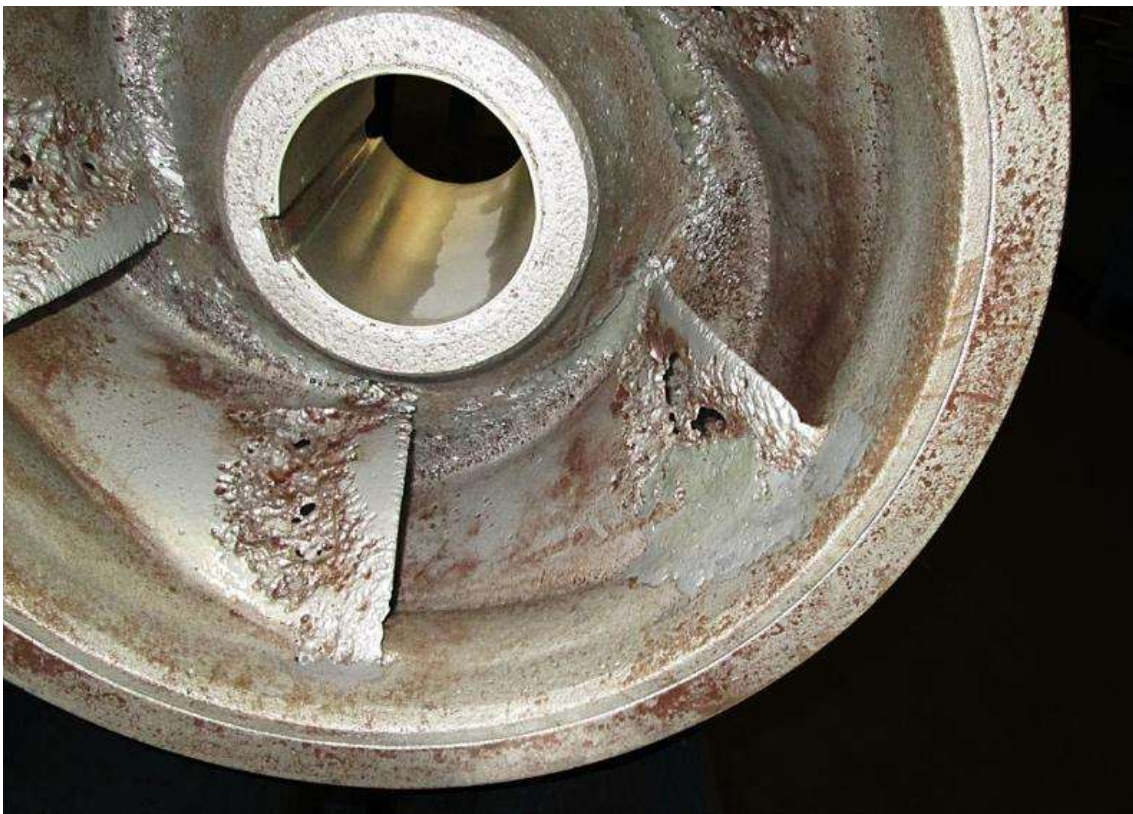
Ilustración 7: Daños por cavitación
