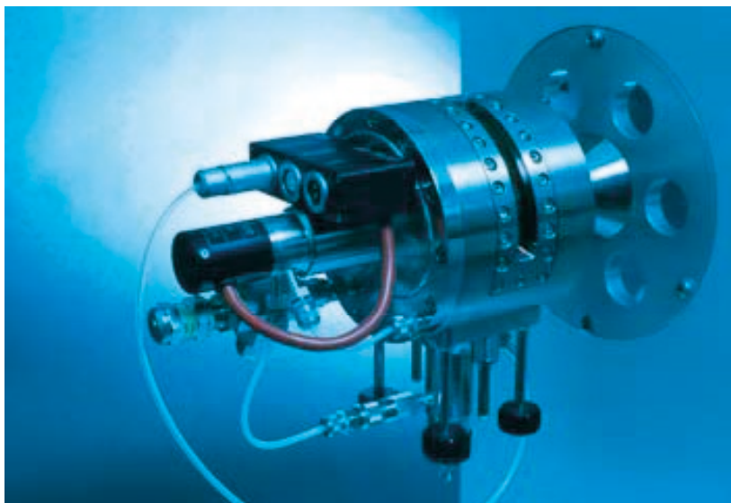
Figura 157. Cambra de T i P variables per l'anàlisi de difracció de raigs X
