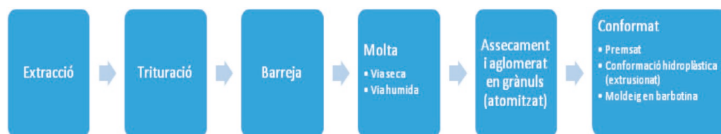
Figura 107. Esquema del processament de les argiles fins a l'etapa de conformat. Adaptat de Ciencia de los materiales , W. D. Callister, Ed. Reverté, Barcelona
