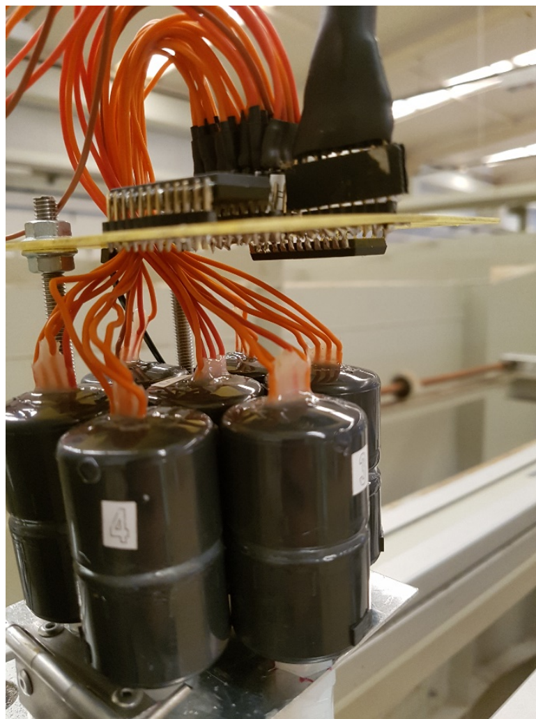
Figura 35 - Caixas estanques com sensores de pressão.
