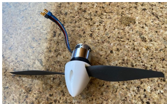
Figura 13 - Conjunto Motor e Hélice da Aeronave Volantex Ranger 757-4
