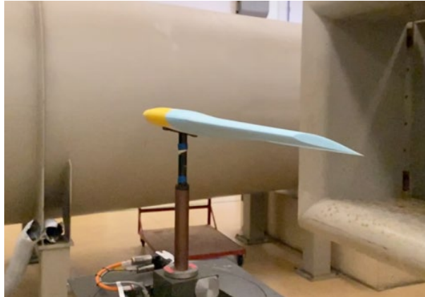
Figura 48 - Modelo Inserido no Túnel Aerodinâmico
