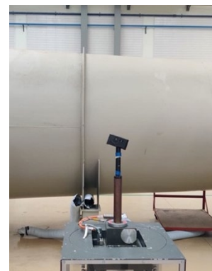
Figura 50 - Bloco e Suporte Túnel Aerodinâmico
