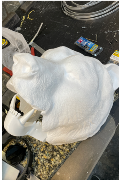
Fig.53 Cabeça em esferovite corte CNC e mandíbula em impressão 3D. Realizado pela autora
