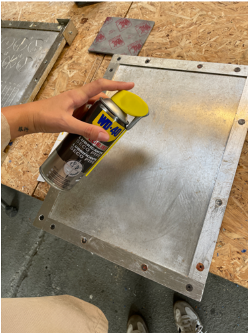
Fig.167 Pulverizar a superfície toda do molde com WD-40 Lubrificante Seco. Realizado pela autora
