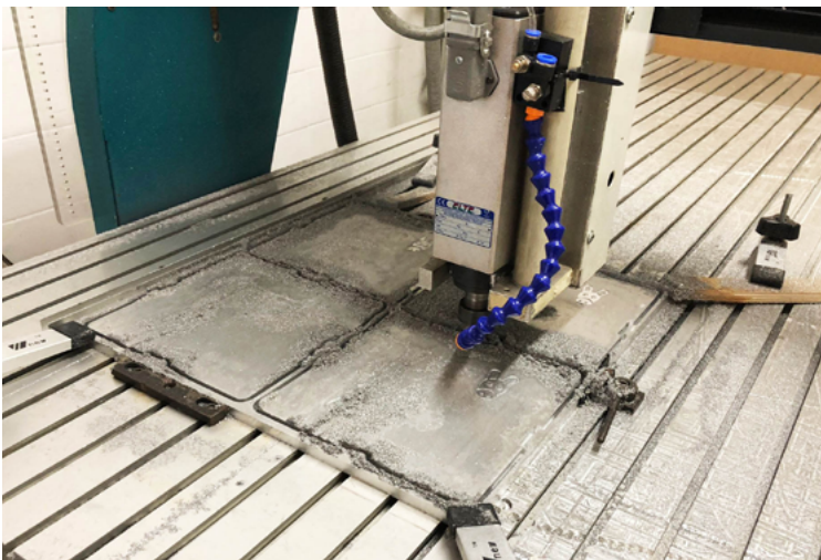
Fig.69 Corte 3D em CNC dos moldes. Realizado pela autora
