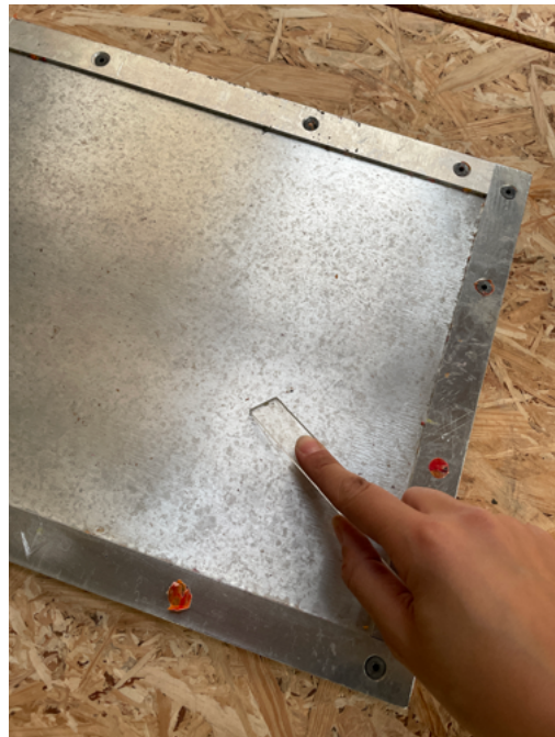
Fig.174 Limpeza do interior do molde com peça de acrílico para não danificar o molde. Realizado pela autora
