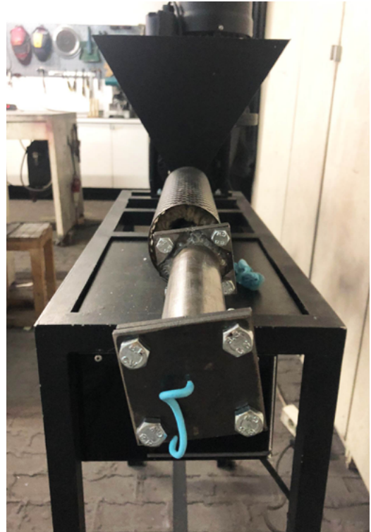
Fig.80 Injeção do plástico no molde através da extrusora. Retirado do álbum do projeto Replay
