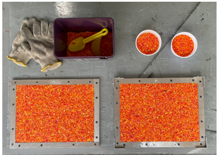
Fig.168 Colocação da primeira dose de plástico no molde e preparação da dose seguinte. Realizado pela autora
