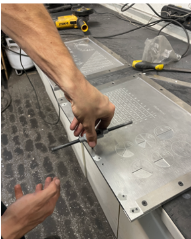
Fig.123 Montagem peças do molde. Realizado pela autora
