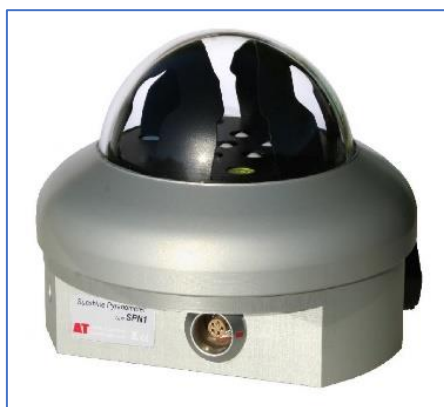
Figura 7.18 - Piranômetro: Medição simultânea de radiação difusa e direta
