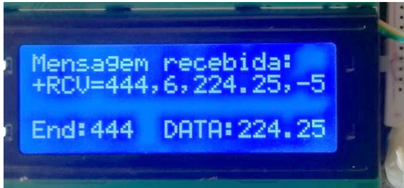
Figura 4.14 - LCD - Exemplo de recepção do valor de tensão
