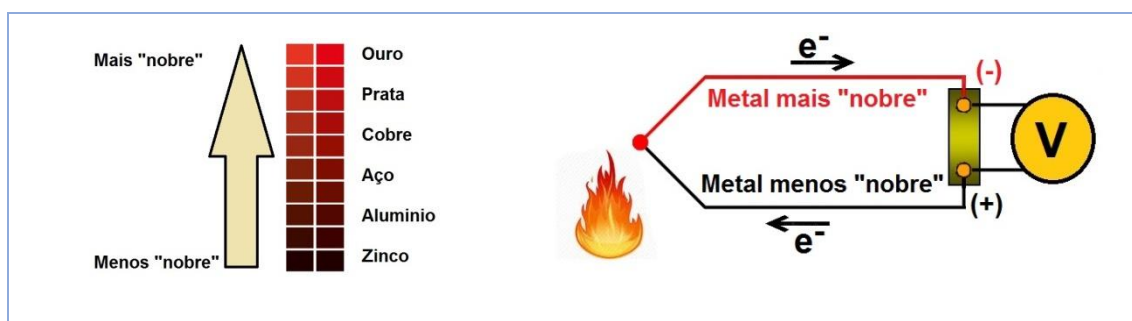
Figura 7.10 - Corrente eletrónica em metais dissimilares
