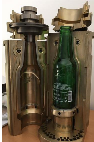
Figura 8 – Articulação entre uma garrafa de vidro e os moldes e acessórios necessários para a sua produção (fase de finalizar).
