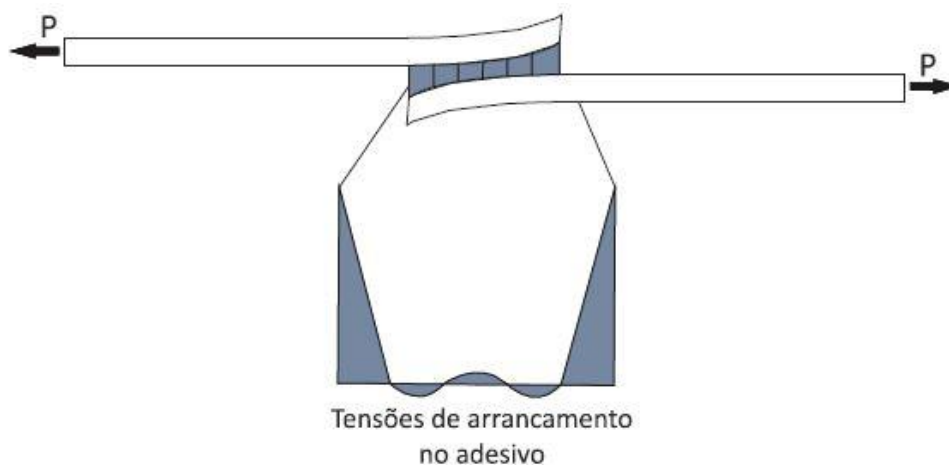
Figura 13 - Tensões de arrancamento numa JSS [26]
