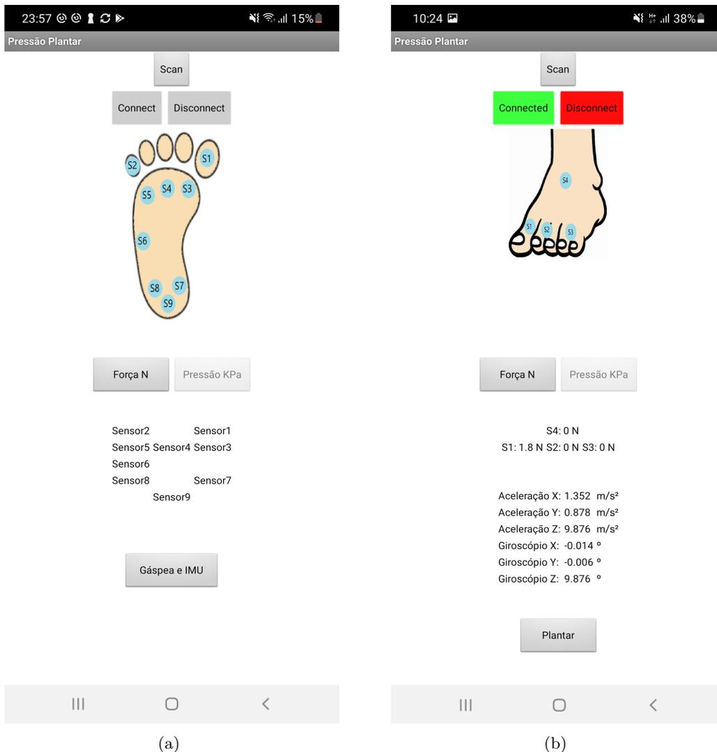
Figura 5.11: Vista da aplicação para *Smartphone* (a) inicial; (b) Gáspea e IMU
