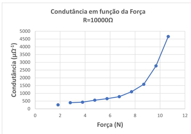
Figura 6.14: Gráfico Condutância em função da Força para R=10000 Ω para a matriz branca
