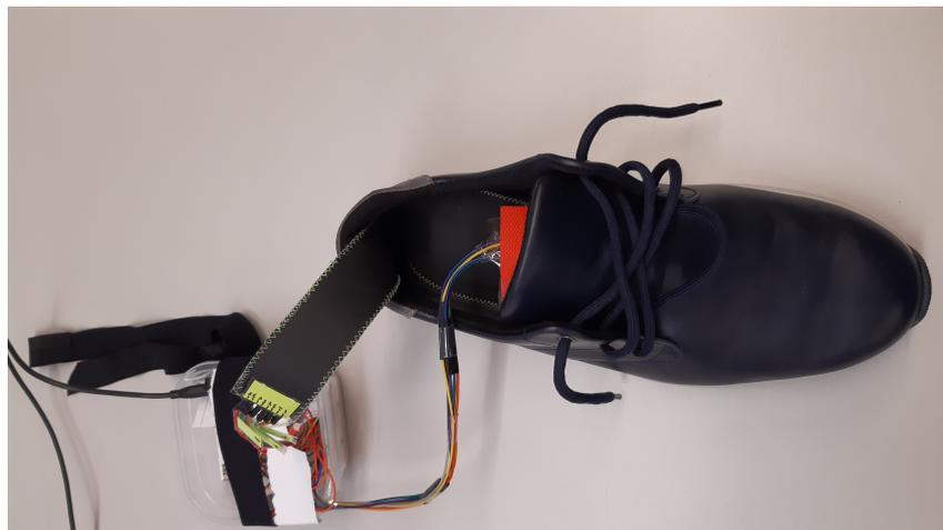
Figura 6.16: Sapato para diabéticos com palmilha de sensores e aplique na gáspea
