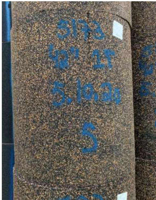
Figura 4 - Cilindro de cortiça e borracha [36]
