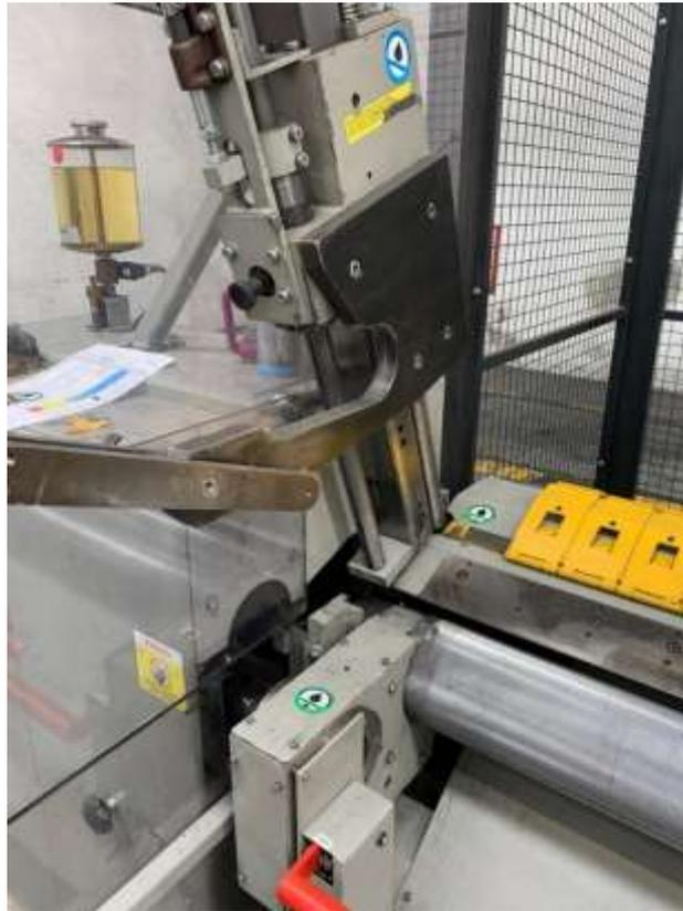
Figura 15 - identificações visuais de manutenção autónoma numa máquina de corte
