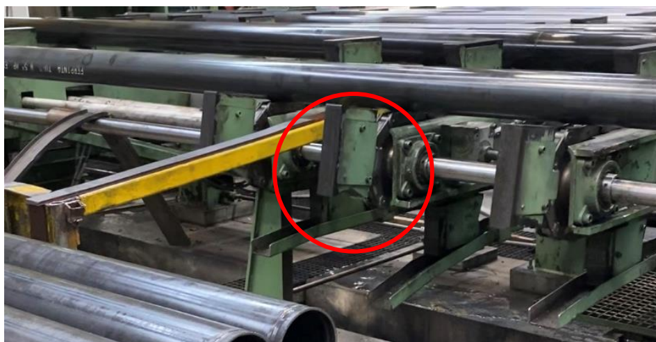
Figura 32 - Entrega dos tubos pela máquina de teste hidrostático
