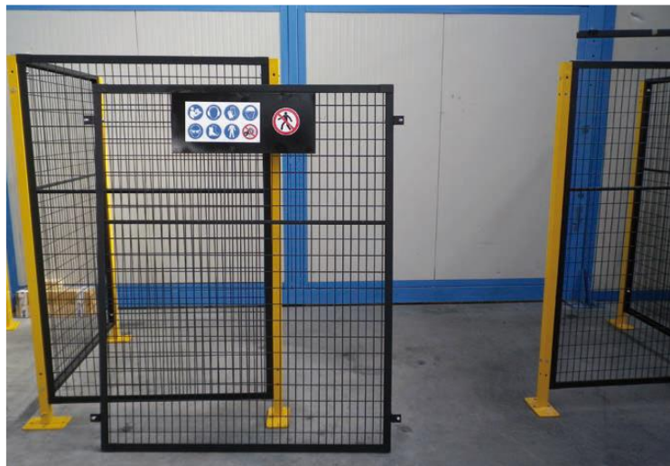
Figura 135 - Exemplo de uma barreira de proteção
