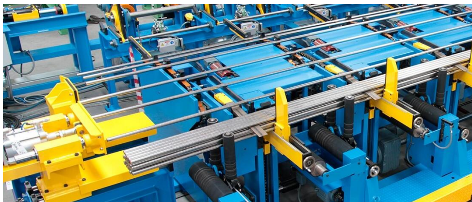
Figura 14 - Empacotadora com movimentação mecânica, retirado de [23]
