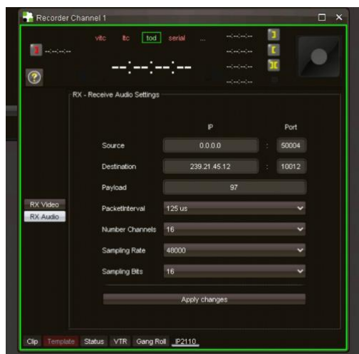
Figura 20 – Configuração Áudio IP 2110
