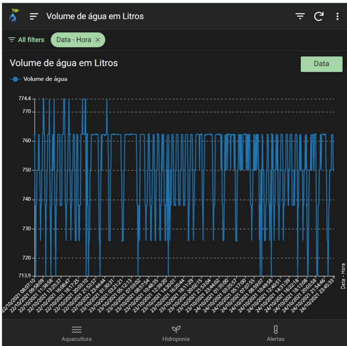
Figura 4.18 - Interface de visualização gráfica dos valores do volume de água nos depósitos.
