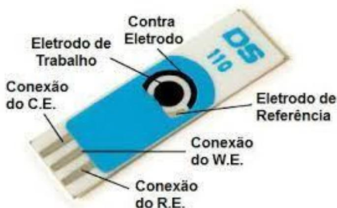
Figura 3.13 – Constituição de um SPE (105).
