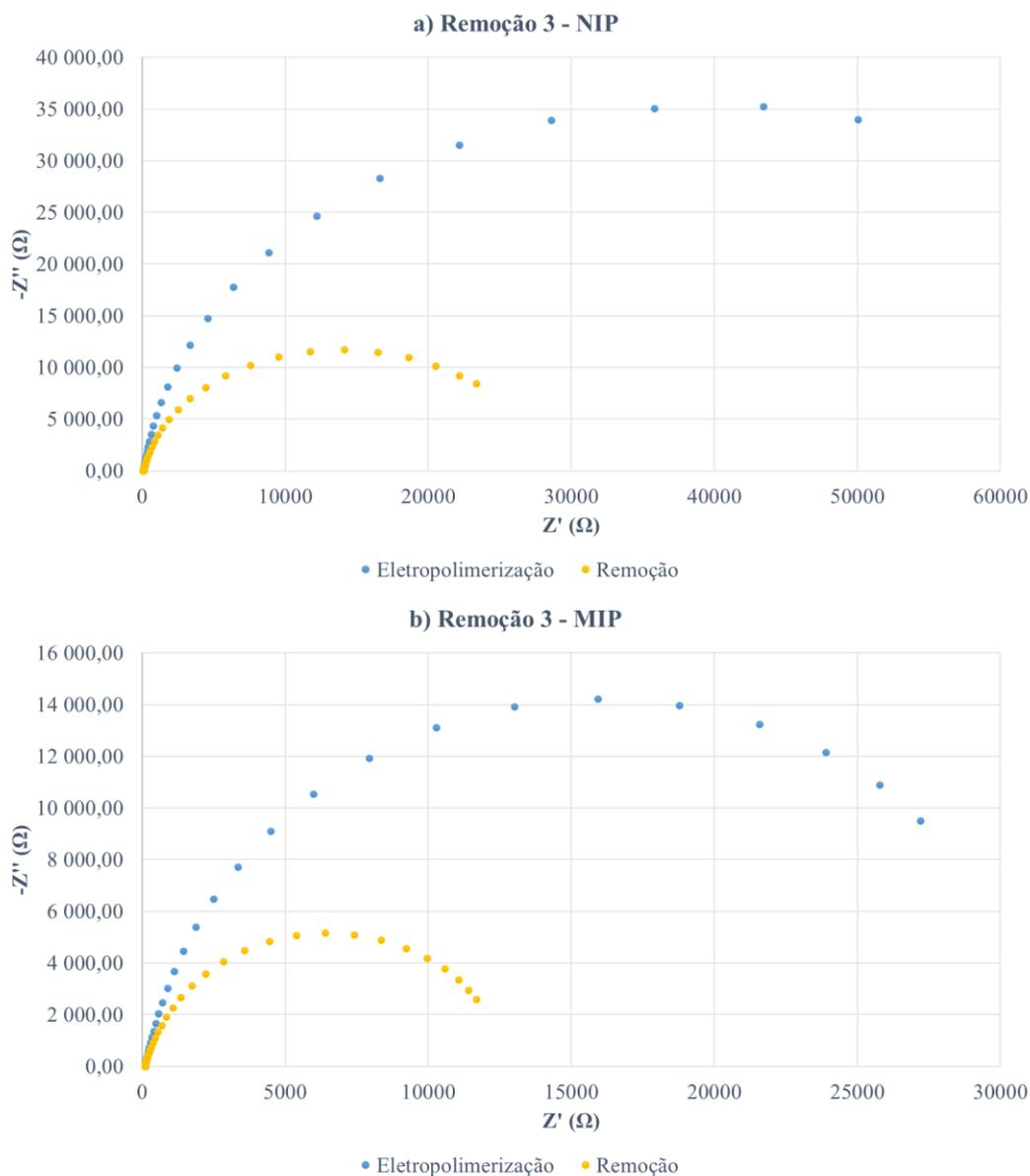
**Figura 5.14** - Diagramas de *Nyquist* da eletropolimerização e remoção do NIP (a) e MIP (b) obtidos para a terceira técnica de remoção estudada, em solução *redox* de ferro.
