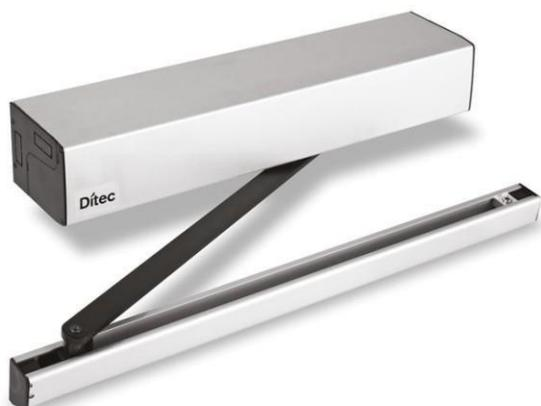
O Diatec DAB105 é um automatismo eletromecânico servoassistido com mola para portas de batente, com motorreductor de 24 Vcc e cinemática gerida por encoder, para uma gestão segura e fiável dos movimentos da porta em qualquer situação.
