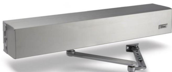
O Diatec DAB205 tem um potentíssimo motorreductor que é acionado na abertura e contribui para o fecho facilitado pela ação de uma mola; a sua performance é a mais alta no seu segmento de mercado, torna automáticas as portas de batente até cerca de 400 kg de peso e 1,6 m de largura.
