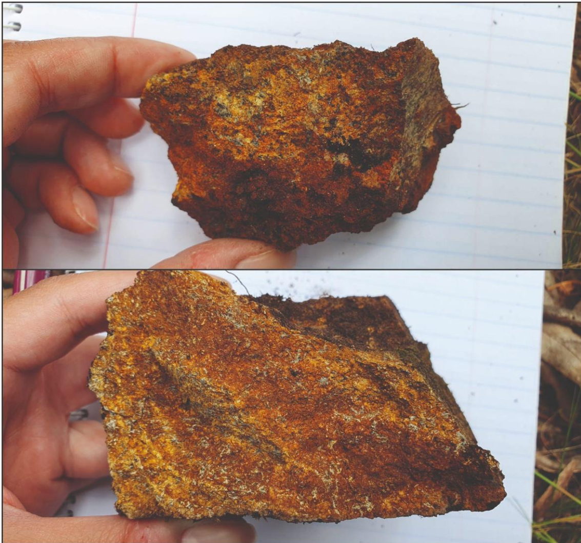
Figura 9 - Fotografia das amostras de mão obtidas no local, evidenciando a intensa ferruginização e grau de alteração da rocha.
