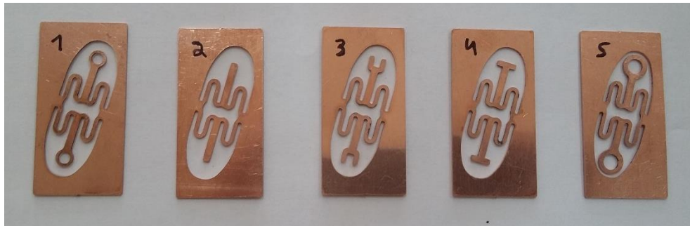
Figura 52 - Geometrias de Terminais.
