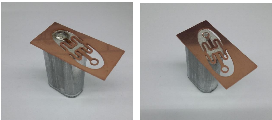
Figura 56 - Provetes de Ensaio Utilizados nos Testes de Tração, Ligados pelos Processos de Brasagem Fraca (à Esquerda) e Soldadura por Pontos (à Direita).
