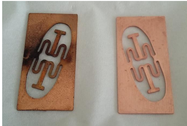
Figura 55 - Terminal em Cobre Antes (à Esquerda) e Após (à Direita) Limpeza.
