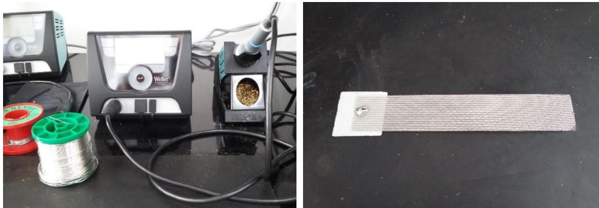
Figura 43 – Equipamento de Brasagem Manual (à Esquerda) e Provete Obtido (à Direita).
