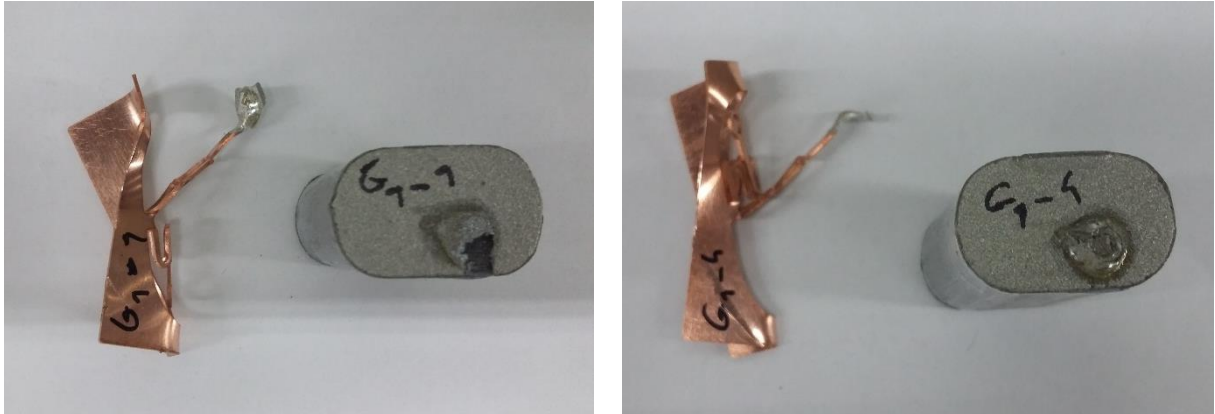
Figura 67 – Ruturas Observadas para a Amostra 1 (Filme Metalizado Visível) e para a Amostra 4 (Rutura pela Segunda Camada de Metalização), Respetivamente, Relativas à Geometria 1.
