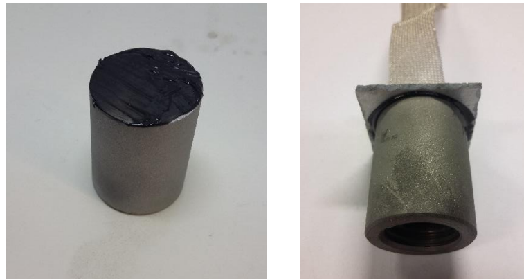
Figura 45 – Aplicação do Adesivo aos Corpos Roscados (à Esquerda) e Disposição deste Elemento no Provete Final (à Direita).
