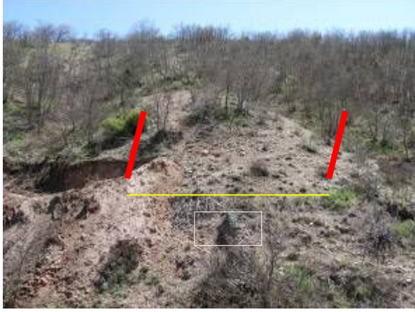
Şekil 2: Dozer verimliliğinin hesaplanması için yapılan işaretlemeler
