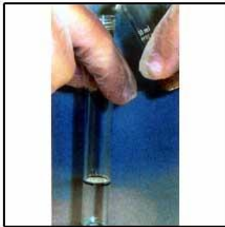
4. Pour solvent into test tube.
