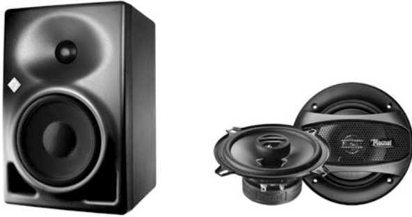
Abb. 2 Elektrodynamische Lautsprecher in unterschiedlichen Bauformen: 2-Wege-System mit Konusmembran als Tieftöner (vgl. Abb. 1) und Kalottenmembran als Hochtöner, für den Einsatz als Nahfeldmonitor im Studiobereich (links). 2-Wege-System als sog. Koaxial-Lautsprecher, mit dem Hochtöner montiert im Zentrum einer Konusmembran (Tieftöner), für den Einbau im Auto (rechts)
