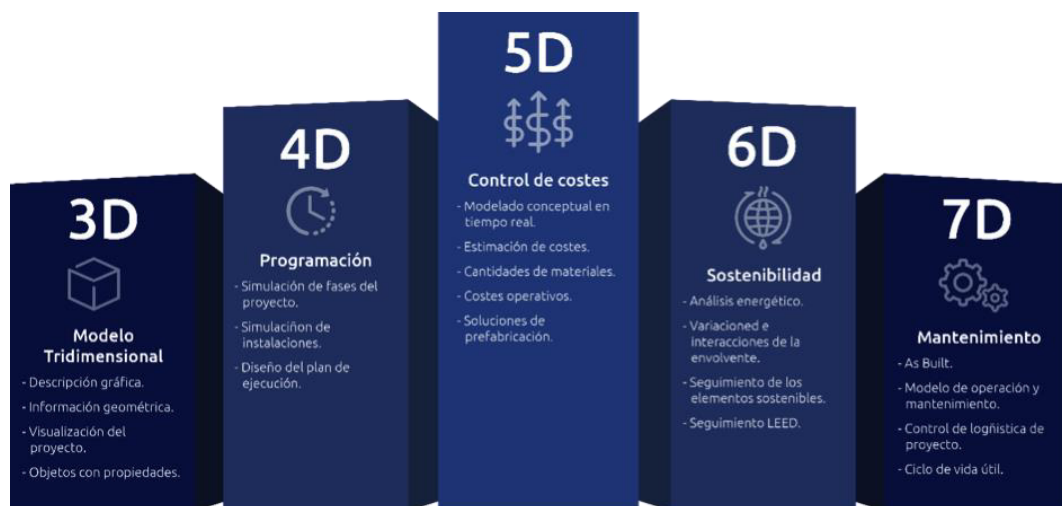
Figura 3-1. Las 7 dimensiones del BIM. Extraída de: http://andreslorenzo.com/bim-construye-el-futuro
