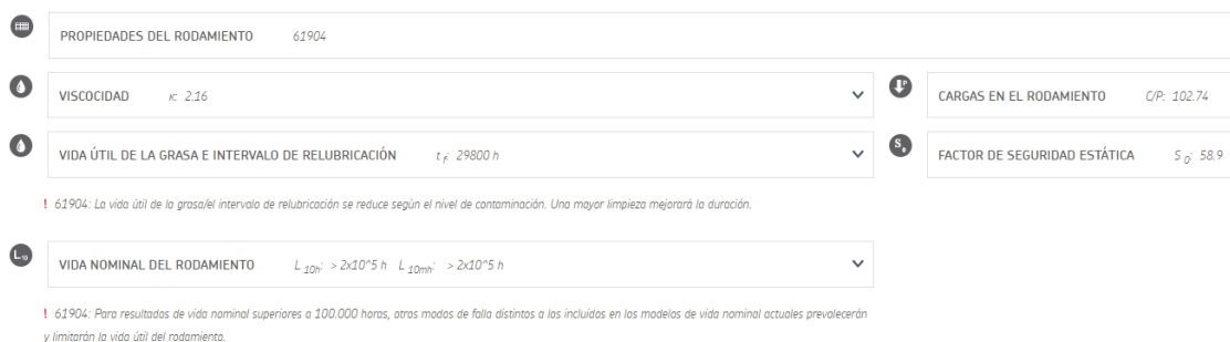
Figura 72. Resultats per al SKF 61904 (Font: Simulador SKF).
