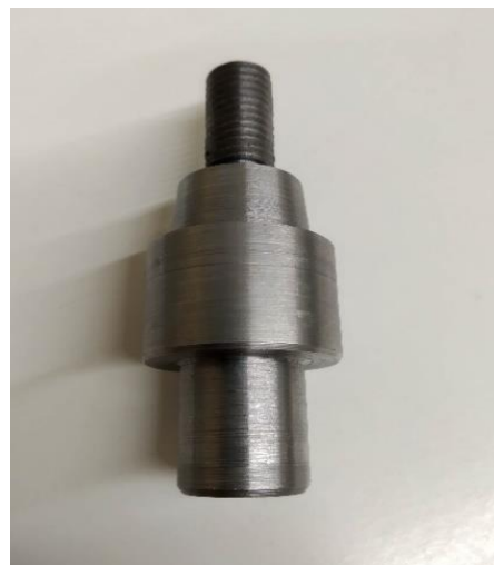
Foto 3.1 Aquí observem una peça que es una practica típica d'escola per un nivell mitjà, on tenim operacions de cilindrada, refrentat, rosca, segat, foradat. Això implica una bona destresa per l'alumna capaç de fer-la correctament
