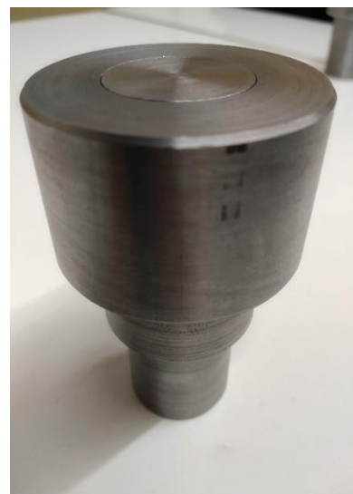
Foto 3.4 Aquí observem com les dues peces de la foto anterior encaixen perfectament. La pràctica, s'anomena ajust cònic i requereix una bona base per a poder-la fer correctament.
