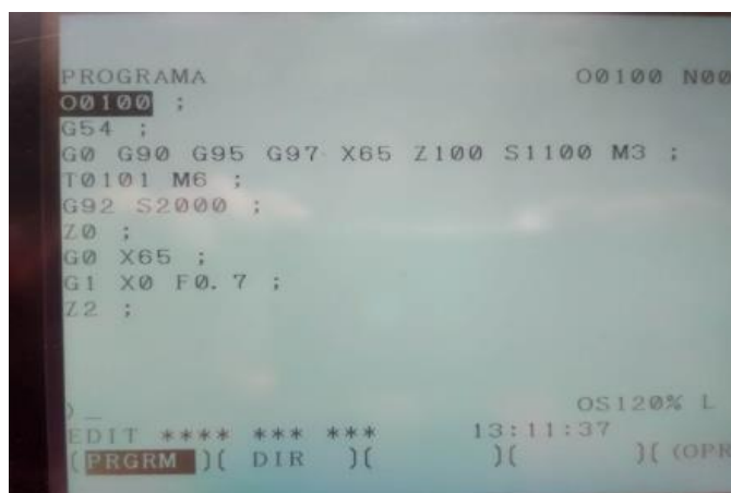
Foto 4.8 Instruccions d'un programa amb control FANUC. A la pantalla es pot apreciar un programa típic, amb les coordenades dels eixos XZ i les instruccions del programa
