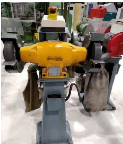
Foto 4.3 Esmoladora, generalment es fa servir per esmolar eines manualment, però també es treu rebaves, ..
