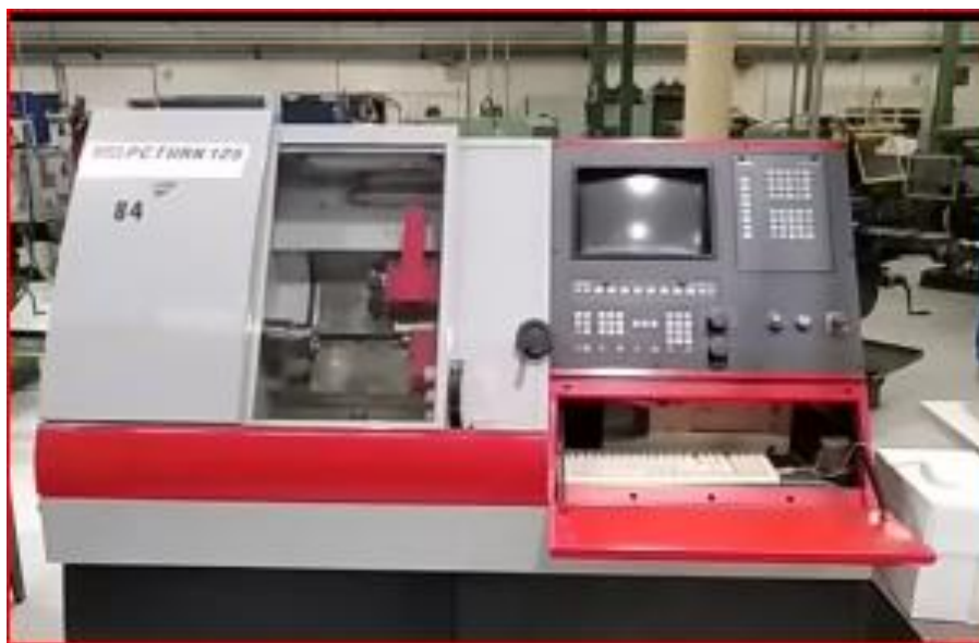
Foto 3.7 Torn CNC amb control Siemens
