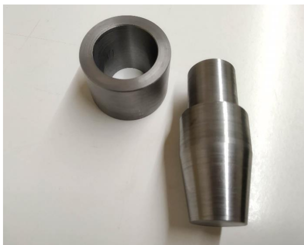
Foto 3.3 Aquí observem una practica típica d'escola per un nivell mitjà, es tracte d'una Virolla cònica a la seva part interior i un eix en canvi de diàmetre amb una zona cònica exterior. Les dues conicitats han d'entrar i quedar anivellades
