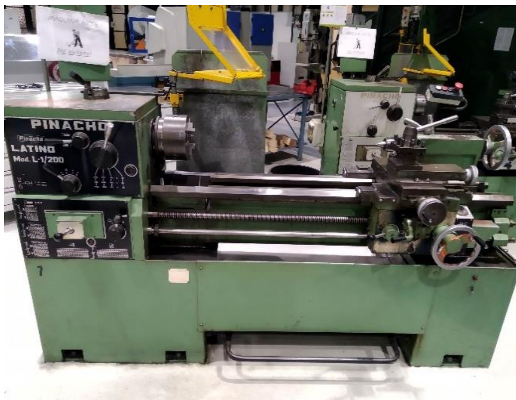
Foto 4.7 Torn convencional típic en escola de FP, però també molt habitual a la indústria pel seu preu, sobretot als tallers de manteniment
