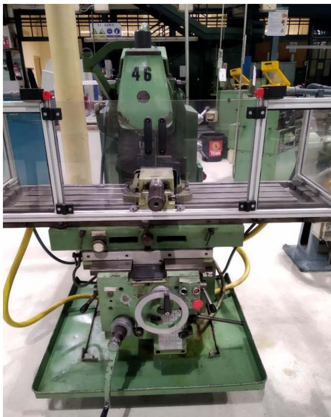
Foto 3.5 Fresadora convencional típica en una escola de FP. Ofereix un gran ventall de possibilitats en l'aprenentatge i de treballs a realitzar, és poden fer peces de gran complexitat. El cost econòmic d'aquesta màquina, més el cost de manteniment, més el cost d'eines i utilitatges, ... Comparant-la amb la vida útil de la màquina resulta molt econòmica degut
