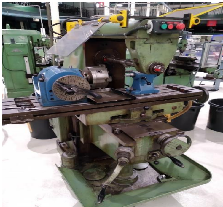
Foto 4.6 Fresadora convencional amb 4rt eix incorporat. Entre la gran varietat d'aplicacions que permet fabricar aquesta màquina, a la FP s'ensenya molt sovint per a fer rodes dentades, xavetes i cares planes als eixos, com per exemple hexàgons. El 4rt eix, és converteix en una eina fonamental en un taller de mecanitzat.
