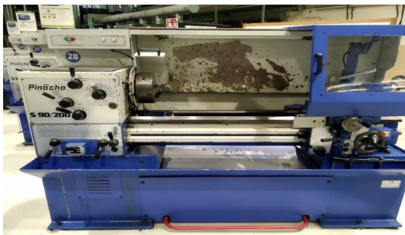
Foto 2.2 Torn convencional típic en un escola de FP que imparteixin l'especialitat de mecanització. Amb aquestes màquines es poden fer
