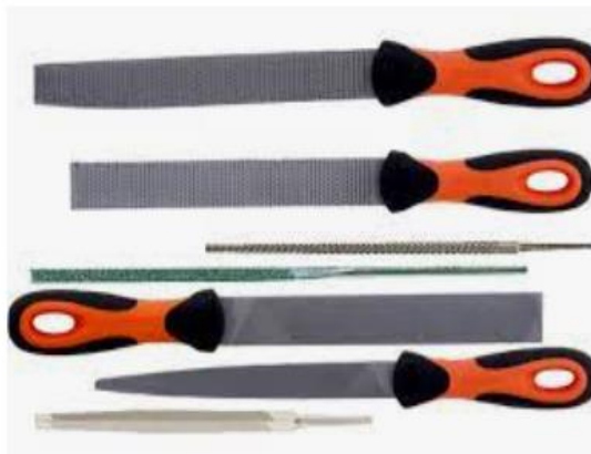
Foto 4.2 Joc de limes, que permeten fer infinitats de treballs com ajusts, treure rebaves, polir superfícies, ...
