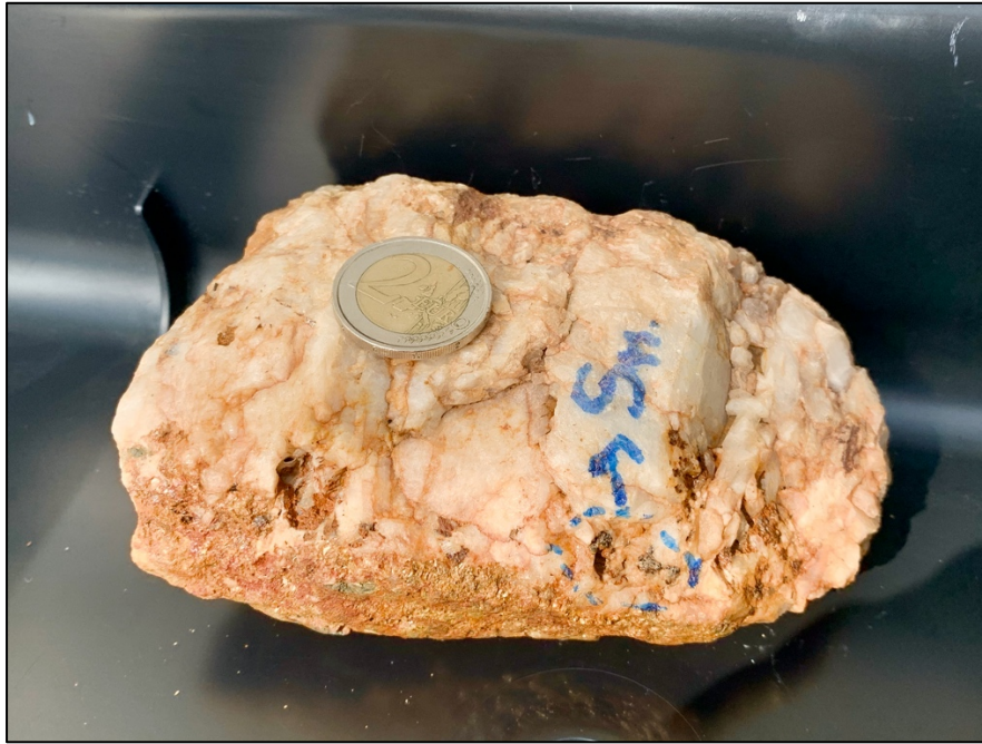
Figura 31. Fragmento de filón con mineralización de Sn (casiterita). Se puede observar, en la parte inferior de la muestra, la salbanda con la moscovitización característica de los sistemas greisen. Fuente propia.
