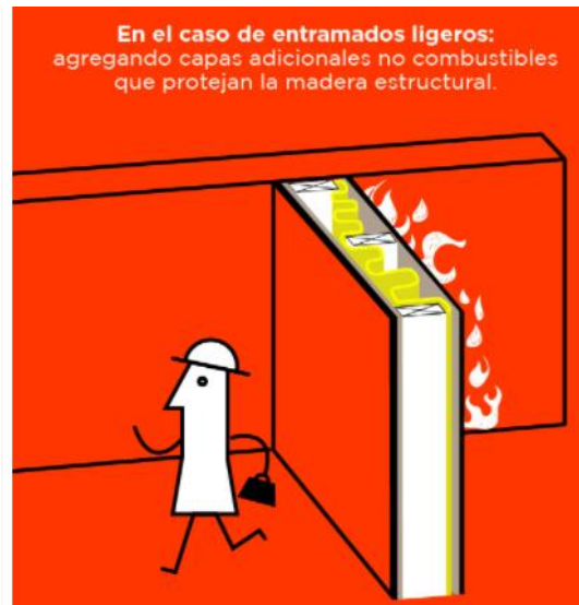
Figura 33: Comportamiento al fuego entramado ligero, Fuente: Madera 21, CORMA.
