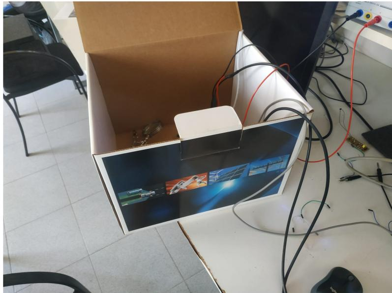
Figura 4.2: Caja utilizada para bloquear la luz externa.
