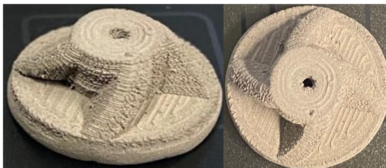
Figura 5.27. Pieza compleja impresa (boquilla 0,5mm)
