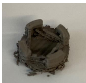
Figura 3.5. Imagen de pieza impresa con flujo excesivo
