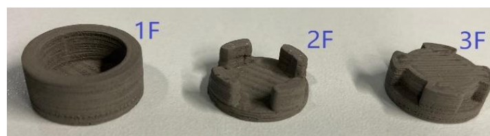
Figura 5.3 figuras impresas con boquilla 0,5
