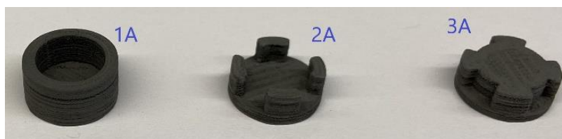
Figura 5.2 figuras impresas con boquilla 0,8
