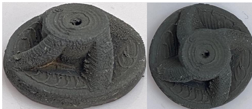
Figura 5.27. Pieza compleja sinterizada (boquilla 0,5mm)
