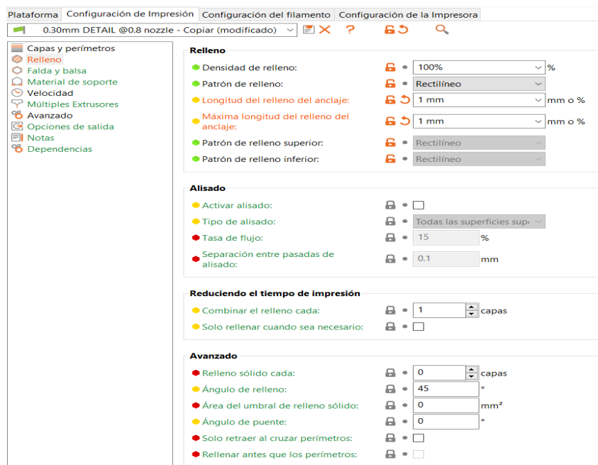
Figura 4.8 configuración impresión (Relleno) PrusaSlicer
