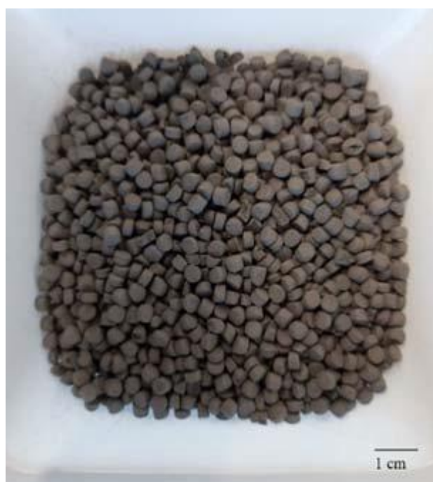
Figura 4.1 Pellets MIM de PolyMIM®
