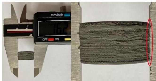
Figura 4.26 Imagen de la izquierda vemos una pieza cilíndrica medida con un pie de rey digital y en la derecha ampliación de la imagen vemos donde se marca con un círculo rojo las mordazas y la zona de contacto de las mordazas con el diámetro exterior de la pieza
