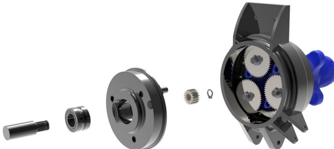
**Figura 3.65.** Ensamblaje del sol, eje motor y portaplanetas motor. (Fuente: Elaboración propia)
