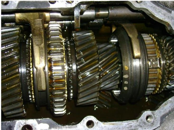
**Figura 3.59.** Lubricación por barboteo de aceite de una transmisión. (Fuente: Konstruktion Traktorer)
