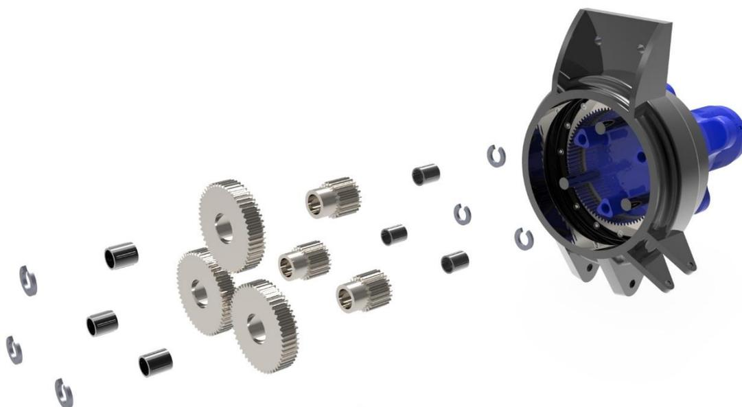
**Figura 3.64.** Ensamblaje del conjunto de los planetas. (Fuente: Elaboración propia)
