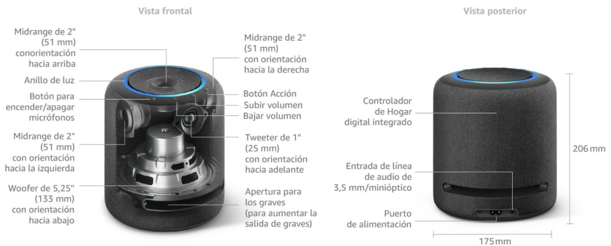
Ilustración 15 Medidas y especificaciones Echo Studio. Fuente Amazon
