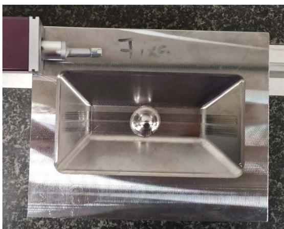
Figura 48.- Perfilómetro en funcionamiento vista planta.
