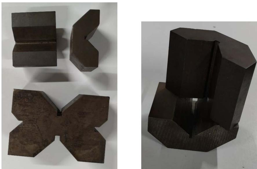
*Figura 29.- Piezas diseñadas para nivelar las muestras a medir.*
