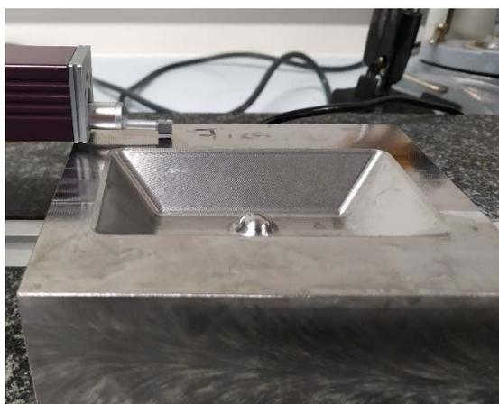
Figura 49.- Perfilómetro en funcionamiento vista perfil.
