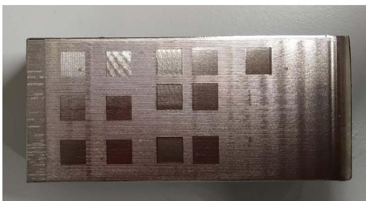
**Figura 28.-** Muestras de 10x10mm bruñidas con la herramienta de puntas intercambiables.
