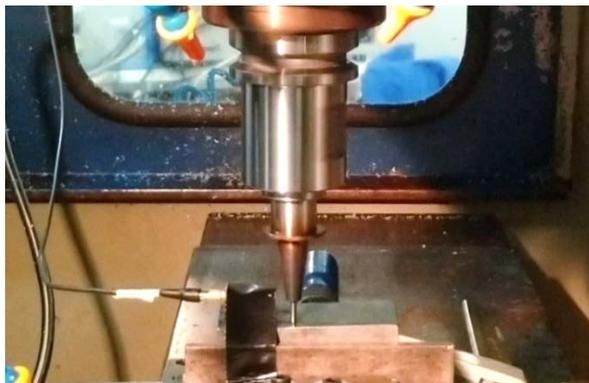
*Figura 2.- Herramienta de bruñido de puntas intercambiables en funcionamiento.*
