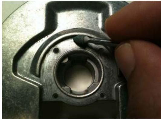
*Figura 1.- Pulido manual de un molde.[2]*
