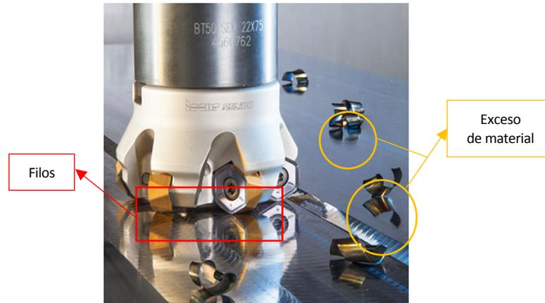
Figura 6.- Ejemplo de una herramienta de fresa con plaquitas hexagonales en funcionamiento.[5]
