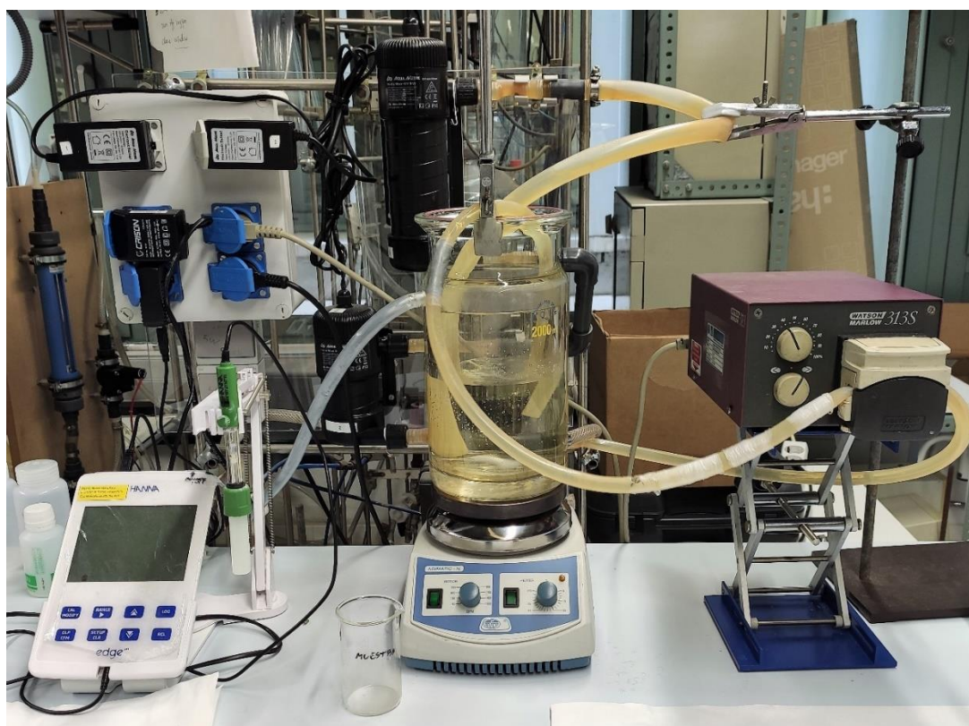
Figura 17. Muntatge experimental on s'han fet els experiments. A la imatge es mostra el reactor, la bomba, el pH-metre, les llums UV i la placa calefactora. Font: pròpia
