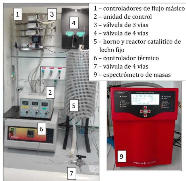
Figura 4.9 Sistema de reacción utilizado para los ensayos catalíticos con el reactor de lecho fijo.
