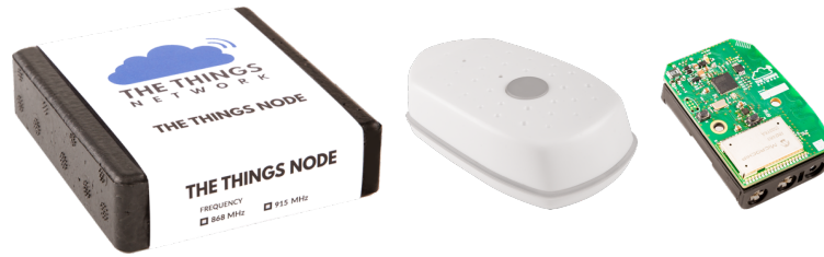
Figura 2.3: Ejemplo de nodo LoRaWAN [21]
