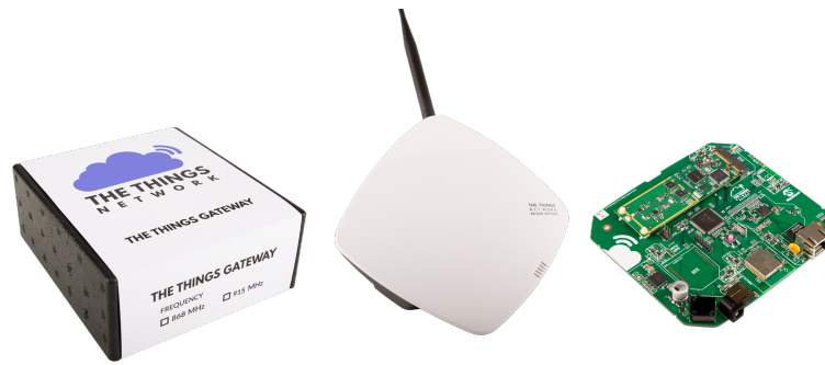
Figura 2.4: Ejemplo de puerta de enlace LoRaWAN [28]
