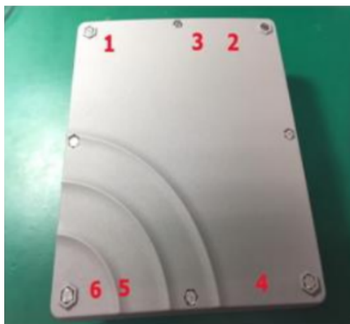
Figura 3.7: Puertos físicos del Gateway ODU Macro [59]
