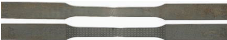
Figura 4: Imagen de las fracturas durante ensayo de tracción JFE - CA 590 marcada y sin marcar
