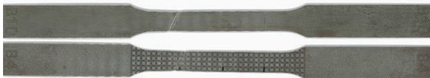
Figura 5: Imagen de las fracturas durante ensayo de tracción JFE - CA 1180 marcada y sin marcar
