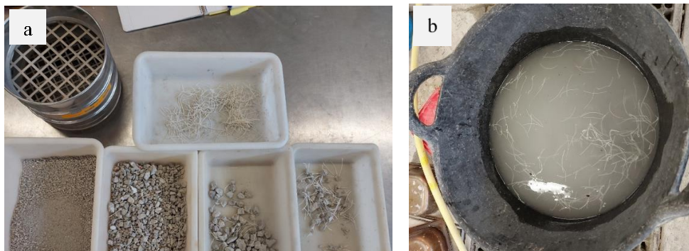
Figura 17. Técnica determinación cuantía de fibras libres: a) Separación manual, b) Flotación
