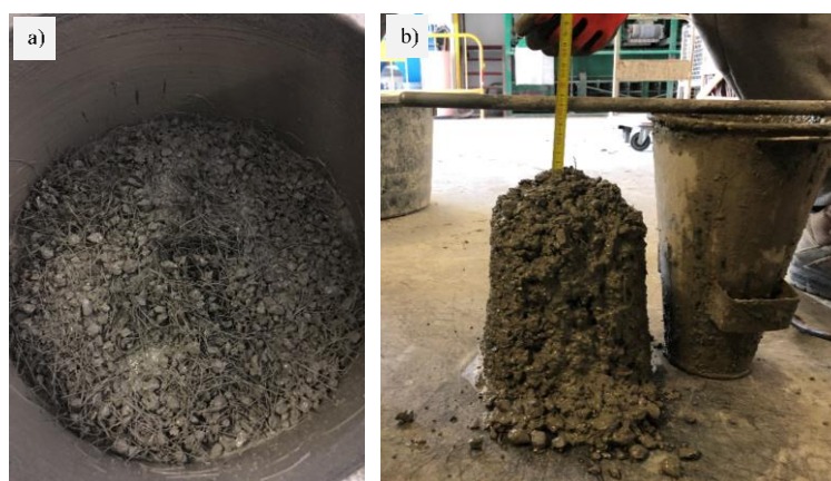
Figura 32. Mezcla 6-RAC-6: a) Aspecto de mezcla, b) Prueba cono de Abrams
