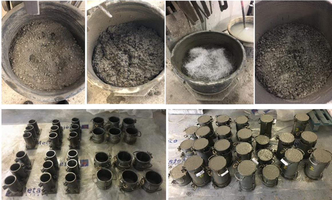
Figura 20. Proceso de fabricación mezclas hormigón
