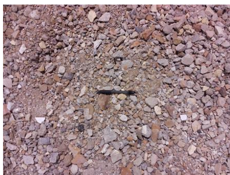
Figura 5. Áridos reciclados cerámicos. Fuente: Gestora de Runes
