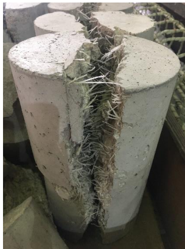
Figura 36. Aspecto de probeta 6-NAC sometida a ensayo de tracción indirecta separada manualmente
