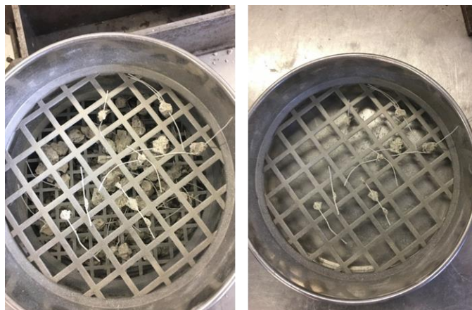
Figura 23. Retención de árido debido a fibra
