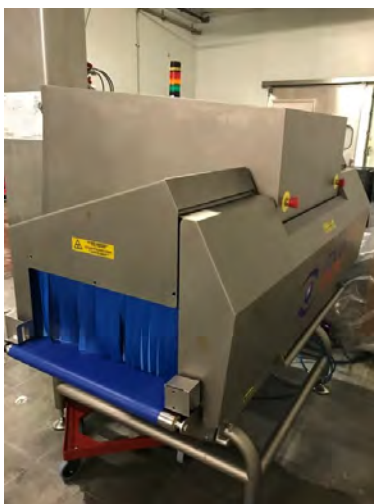
Figura 17: Multiscan de rajos X, model: MXV-MEAT 6025 ADVANCED per mesurar la sal
