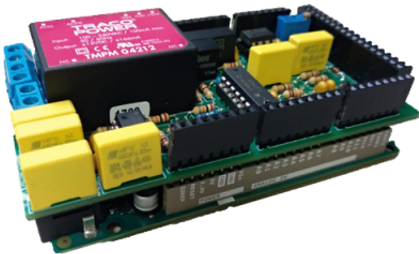
Figura 4: Arduino Due junto con la placa de acondicionamiento de señal.
